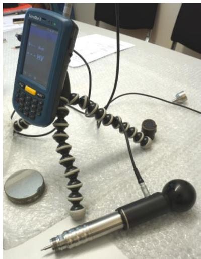
Abbildung 30: Mobiles Härteprüfgerät SonoDur2 mit runder Härtevergleichsplatte der Firma NewSonic GmbH
