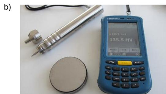
Abbildung 2: a) Optik einer mit PIT-nachbehandelten Schweißnaht; b) mobiles Härtemessgerät SonoDur2 (UCI) der Firma NewSonic GmbH
