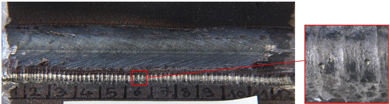
Abbildung 31: Übersicht über Eindruckpunkte der Härtemessung am PIT-nachbehandelten Schweißnahtübergang
