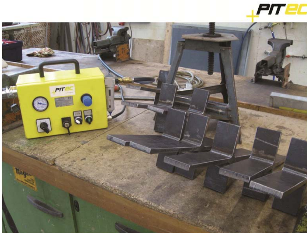
Bild 5: PIT behandelte Proben mit Steuergerät
