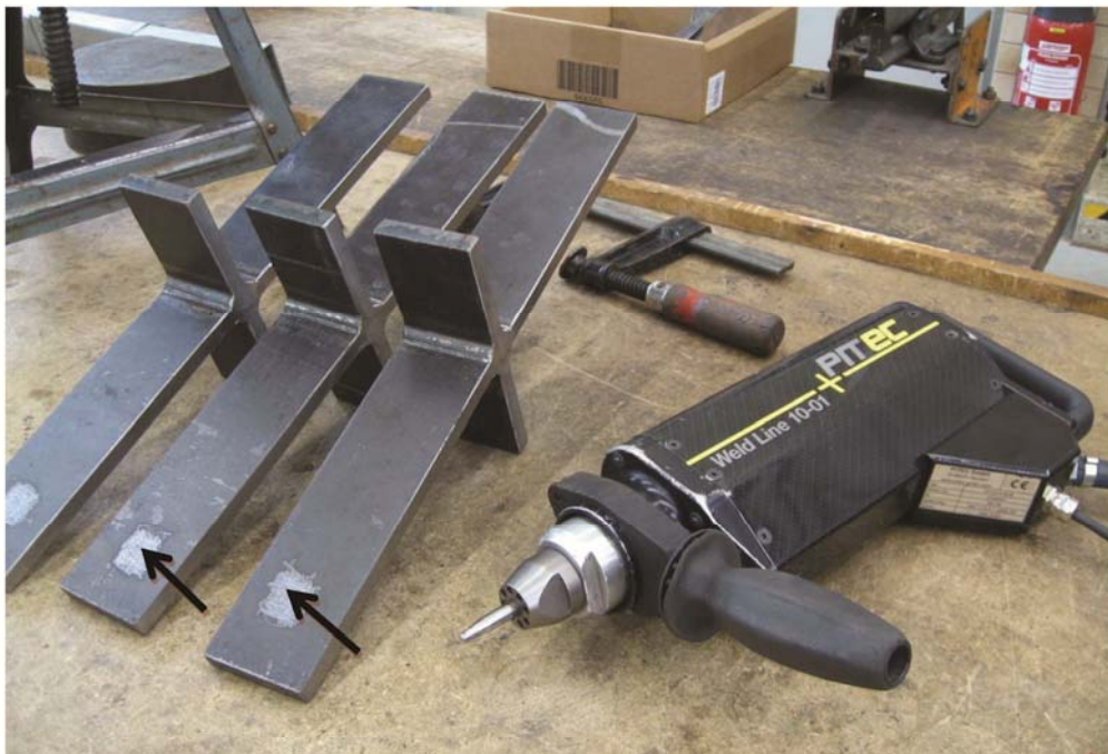
Bild 4: PIT behandelte Proben – an 3 Proben wurden kleine Felder behandelt für eventuell zusätzliche Messungen
