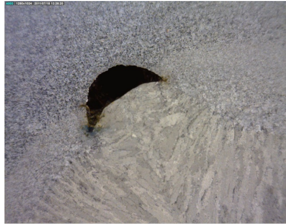
Abbildung 2.33: Wurzelbindefehler 200-fach vergrößert
