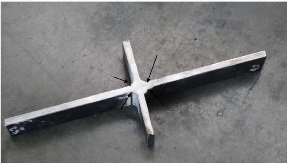
Bild 2: Kreuzprobe auch an den Kanten zu behandelnde Bereiche
