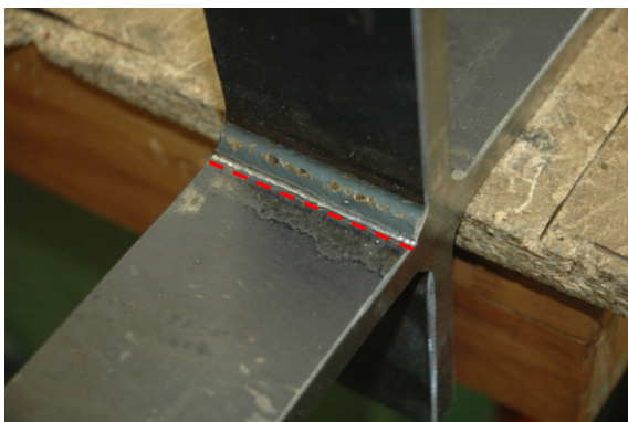
Abbildung 2.16: Lage der nachbehandelten Schweißnahtübergänge
