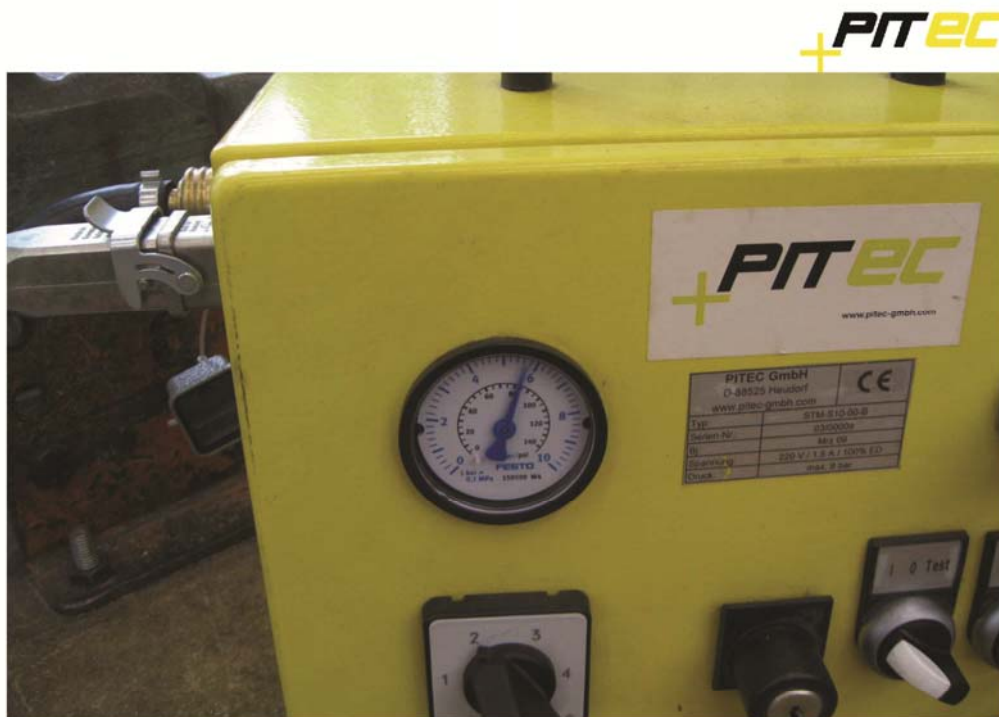
Bild 3: Daten der PIT Behandlung Frequenzschalter Stufe 2 = 90 Hz und 5-6 bar in Betrieb
