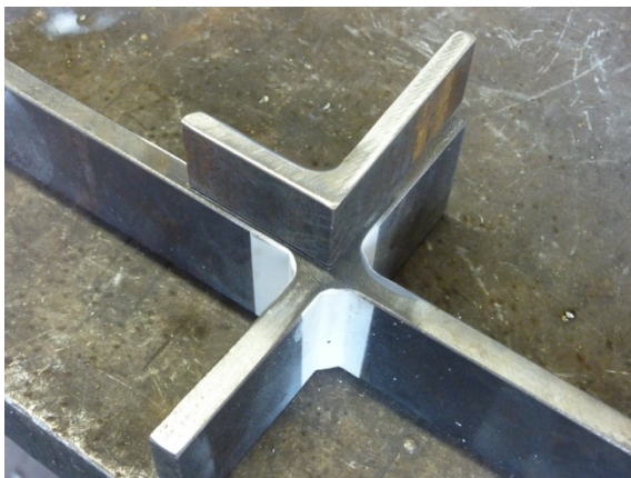
Abbildung 2.30: An- und Auslaufwinkel
