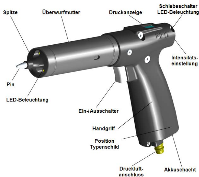
Abbildung 1.3: HiFIT Handgerät [14]
