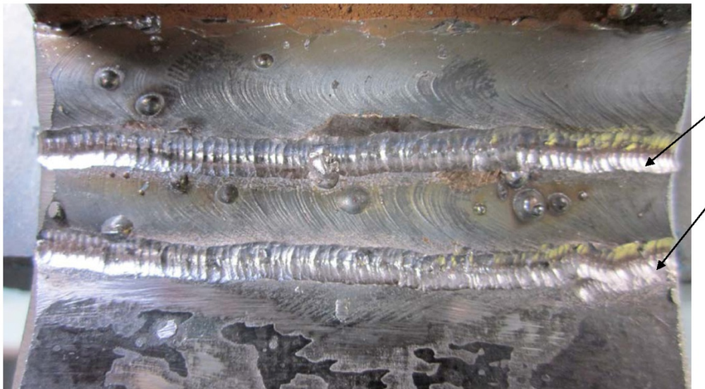
Bild 6: An den Schweißnahtübergängen behandelt
