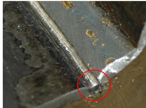
Abbildung 2.19: HiFIT-nachbehandelter Versuchskörper mit seitlichem Grat
