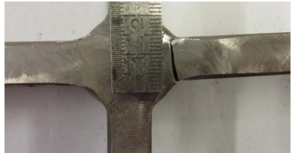
Abbildung 2.11: Seitenansicht Anriss Pk. 1.1.5
