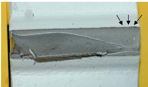
Abbildung 2.23: Bruchfläche mit markiertem Bruchausgang Pk. 2.2.9
