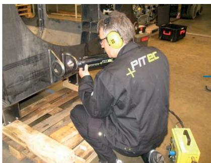
Bild 9. PIT-Behandlung der Nahtübergänge an den mit umlaufenden Kehlnähten befestigten Lagerösen
