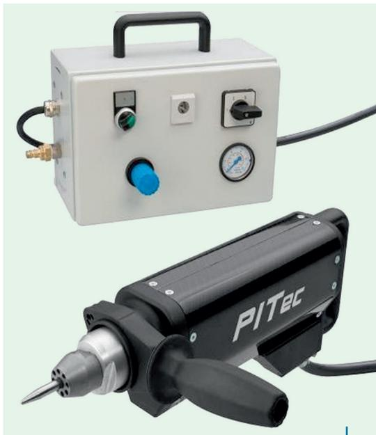
Bild 3. Die transportable Ausrüstung für die PIT-Behandlung erfordert nur einen Druckluft- und einen Stromanschluss (230 V)
