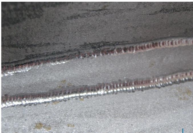
Bild 13. Im Normalfall ausreichende Spuren an den beiden Schweißnahtübergängen
