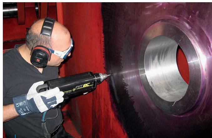
Bild 10. Bei der PIT-Behandlung der eingeschweißten Lagerbuchse einer Presse eines französischen Lastkraftwagenherstellers
