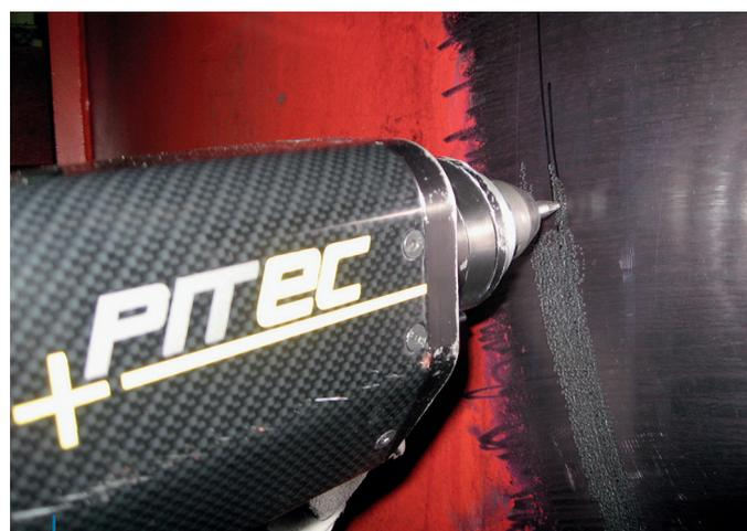
Bild 11. Behandlung der gesamten Oberfläche der Schweißnaht
