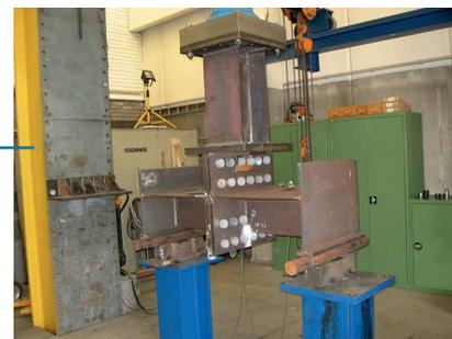
Bild 16. Geschweißtes Bauteil auf dem Prüfstand der Universität Innsbruck zur Ermittlung der Schwingfestigkeit
