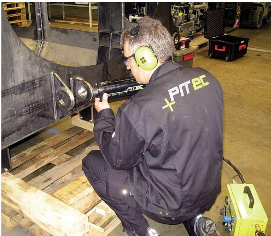
**Bild 3:** Die kompakte Bauform sowie der geringe Luftverbrauch des pneumatischen Systems ermöglichen einen Einsatz direkt vor Ort.
