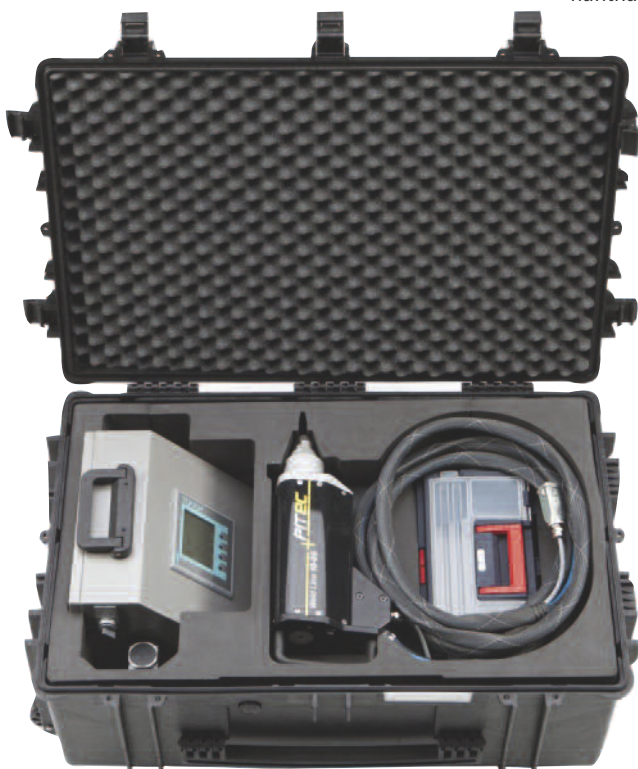
◀ Bild 2. Transport- koffer mit Ausrüstung für das höherfrequente Hämmernverfahren „PIT“
