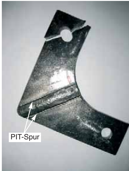
Bild 5. Bruch bei 417000 LW (Bilder: PITEC)
