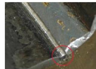
SMS Siemag baut den ersten Pfannendrehturm bei dem die höchst belasteten Nähte mit der PIT Technologie nachbehandelt werden um die ohnehin hohe Lebensdauer Ihrer Anlage noch nachhaltiger zu gestalten. Auch bei Reparaturen möchte die SMS künftig auf die PIT Technologie setzen.
